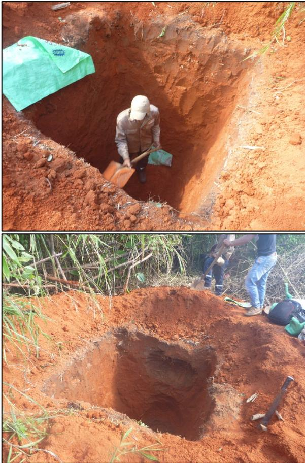
**Figura 4. Procedimiento de Identificación y descripción de calicatas (CAL-01).**
